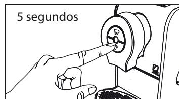
Cuando la máquina entre en el modo de programación, es más rápido el destello de led de la tecla seleccionada (frecuencia doble).
